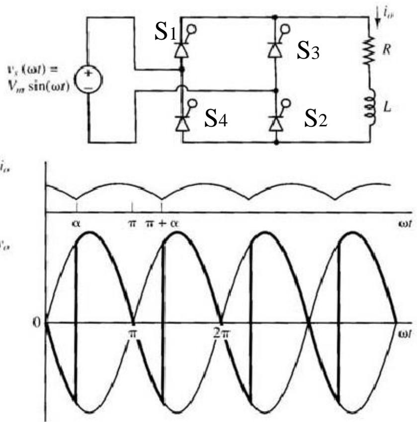
$$v_o(\omega t) = V_o + \sum_{n=2,4,\dots}^{\infty} V_n \cos(n\omega t + \pi)$$
